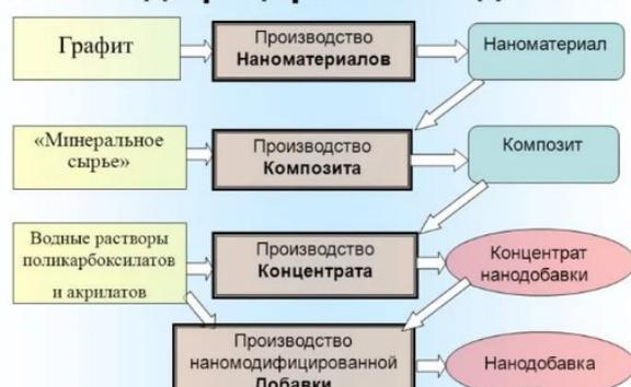
Рисунок 4 Технология производства наномодифицированных добавок
