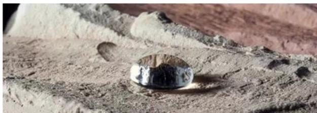
Рисунок 3. Достоинство бетонов с кристаллообразующей добавкой.
