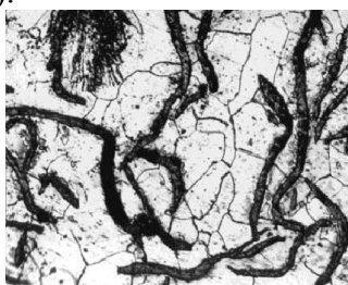
Рисунок 20 - Микроструктура серого чугуна на а – ферритной, б - ферритно-перлитной, в - перлитной основе
