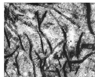
Рисунок 20 - Микроструктура серого чугуна на а – ферритной, б - ферритно-перлитной, в - перлитной основе
