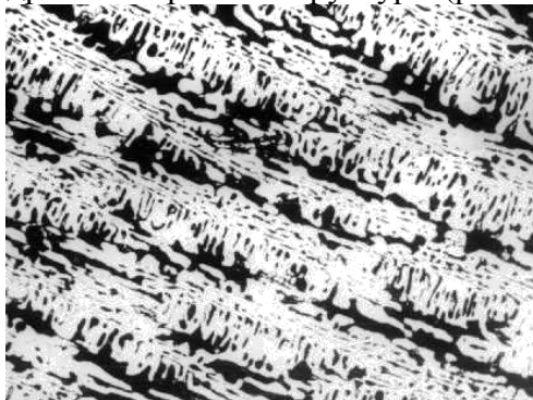
Рисунок 17 - Микроструктура эвтектического чугуна с содержанием углерода 4,3%
