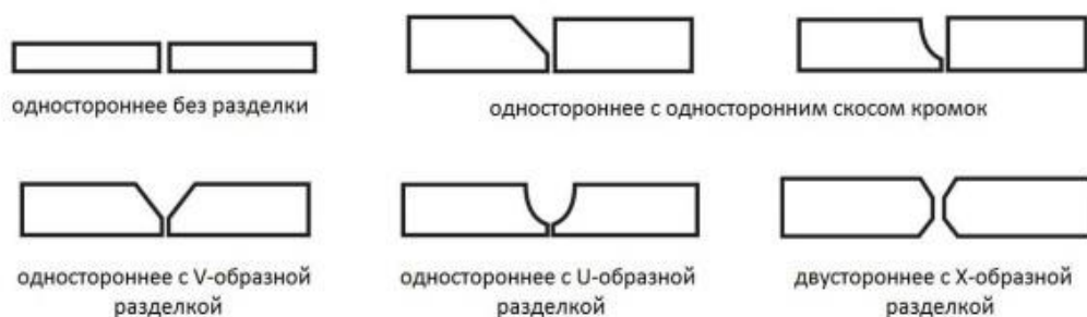
Рисунок 34. Способы разделки кромок при стыковом соединении.
