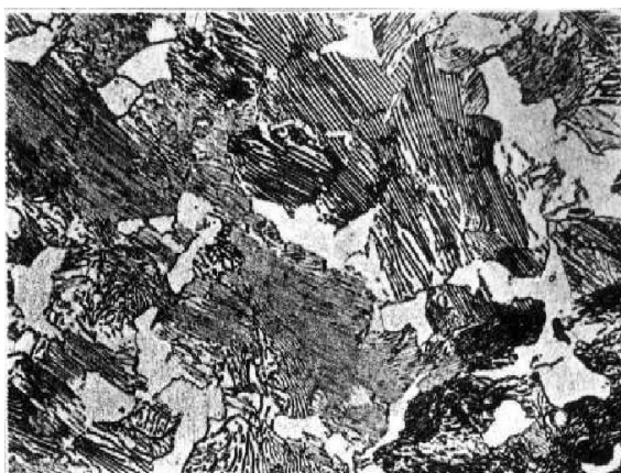
Рисунок 13 - Микроструктура доэвтектоидной стали с содержанием 0,6%С
