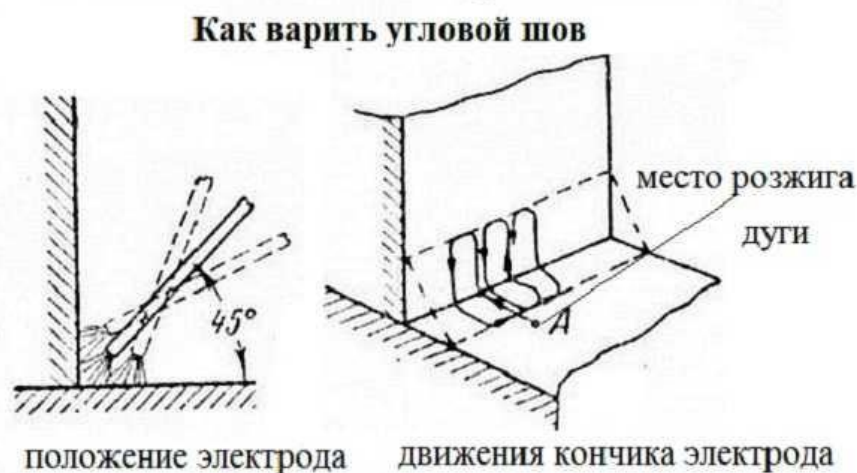
Рисунок 41. Сварка углового шва — положение и движение электрода
