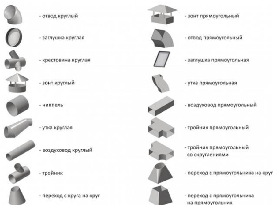
Рисунок 27. Виды соединений деталей воздуховодов
