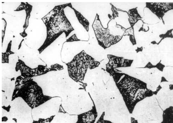
Рисунок 11 - Микроструктура доэвтектоидной с содержанием углерода 0,45% (стали 45)
