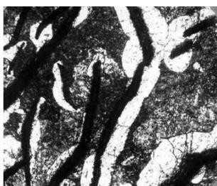
Рисунок 20 - Микроструктура серого чугуна на а – ферритной, б - ферритно-перлитной, в - перлитной основе
