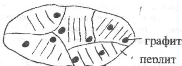
Рис. 23. Структура высокопрочного чугуна
