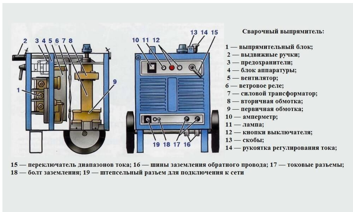
Рисунок 33 . Устройство сварочного выпрямителя.
