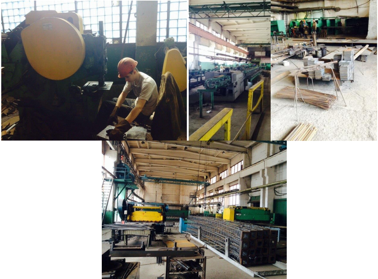
Рисунок 1 –Арматурный цех - изготовление каркаса для базового изделия
