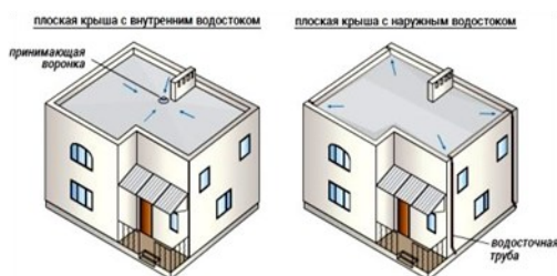
Рис.1 Виды плоских крыш в зависимости от типа водосточной системы
