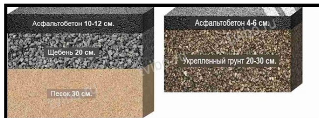
Рисунок 1. Пример применения укрепленного грунта при устройстве основания дорожной одежды с асфальтобетонным покрытием.
