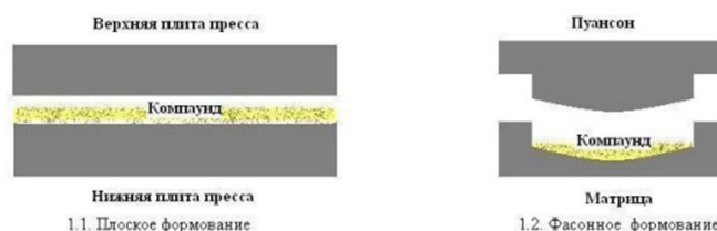
Рисунок 3. Принципиальная схема процесса прессования изделий из ДПК из гранулированного композита
