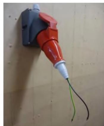
Подготовленные разъёмы соединяются с соответствующими разъёмами ЭУ. К полученным проводникам подключаются электроды мегомметра. Напряжение – 250, 500В.
